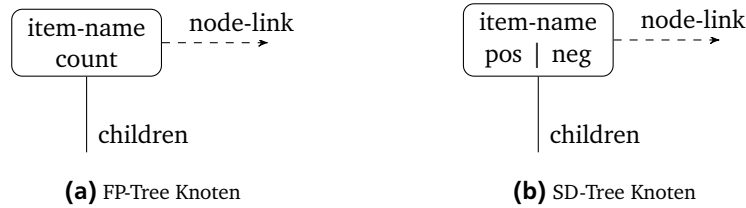
Abbildung 2.12.: Vergleich eines FP-Tree - Knotens zu einem SD-Tree - Knoten
